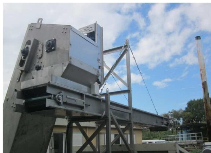
Il nastro trasportatore a tela è maggiormente utilizzato per il trasporto di grigliati e fanghi in impianti di depurazione delle acque ed impianti industriali in genere.
