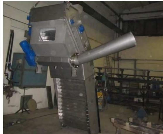
La macchina è appositamente studiata per la separazione di corpi solidi come stracci, pezzi di legno, frammenti di piante, carta, ecc. di effluenti civili ed industriali.
