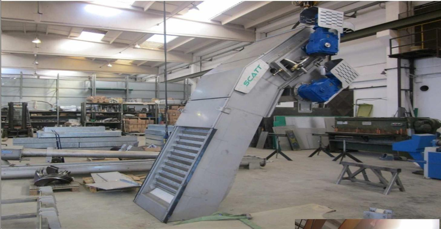
La griglia a tapparelle è una griglia automatica fine, a ciclo continuo e autopulente. Il tappeto filtrante è costituito da una serie di pannelli in aisi 304 montati su alberi paralleli (facilmente sostituibili) anche questi in acciaio inossidabile il tutto installato su robusto telaio. Il tappeto filtrante scorre su rulli laterali in aisi 304 che appoggiano su guide in piatto 40x20 che garantisce una vita lunghissima alla macchina senza dover intervenire per manutenzione alle slitte.
