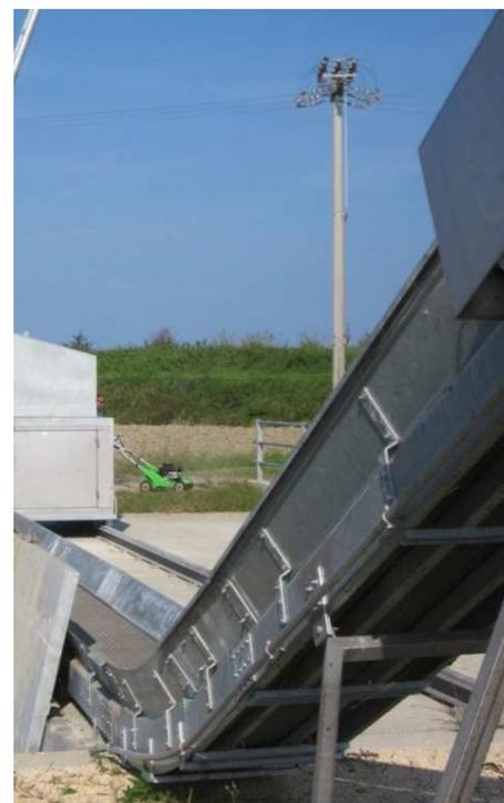
Il nastro a rete metallica di acciaio inox aisi 304 è generalmente usato per trasporto di materiali quali risulda da scoli, canali, tipo legname, arbusti. La costruzione del nastro trasport-elevatore metallico è tale da consentire, con una struttura continua, il trasporto e l'elevazione del materiale grigliato, in quanto la particolare costruzione della macchina permette con una struttura unica e continua l'allontanamento del materiale da qualsiasi profilo di grigliatura.
