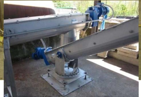
Le coclee di trasporto del tipo senza albero centrale consentono di trasportare prodotti a notevoli distanze con basse potenze e manutenzione ridotta al minimo.
