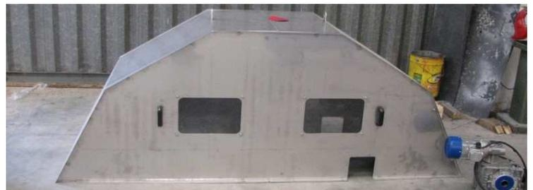
La carpenteria di sostegno è in lamiera pressopiegata a freddo, l'azionamento della macchina avviene mediante un motoriduttore ortogonale. I pettini sgrigliatori sono mossi da un albero motore con supporti monoblocco di estremità.
