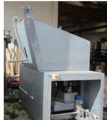
La griglia oleodinamica a postazione mobile è generalmente usata nei canali di bonifica, in quanto ha le capacità di sollevare materiali molto ingombranti come ramaglie e pezzi d'albero.
