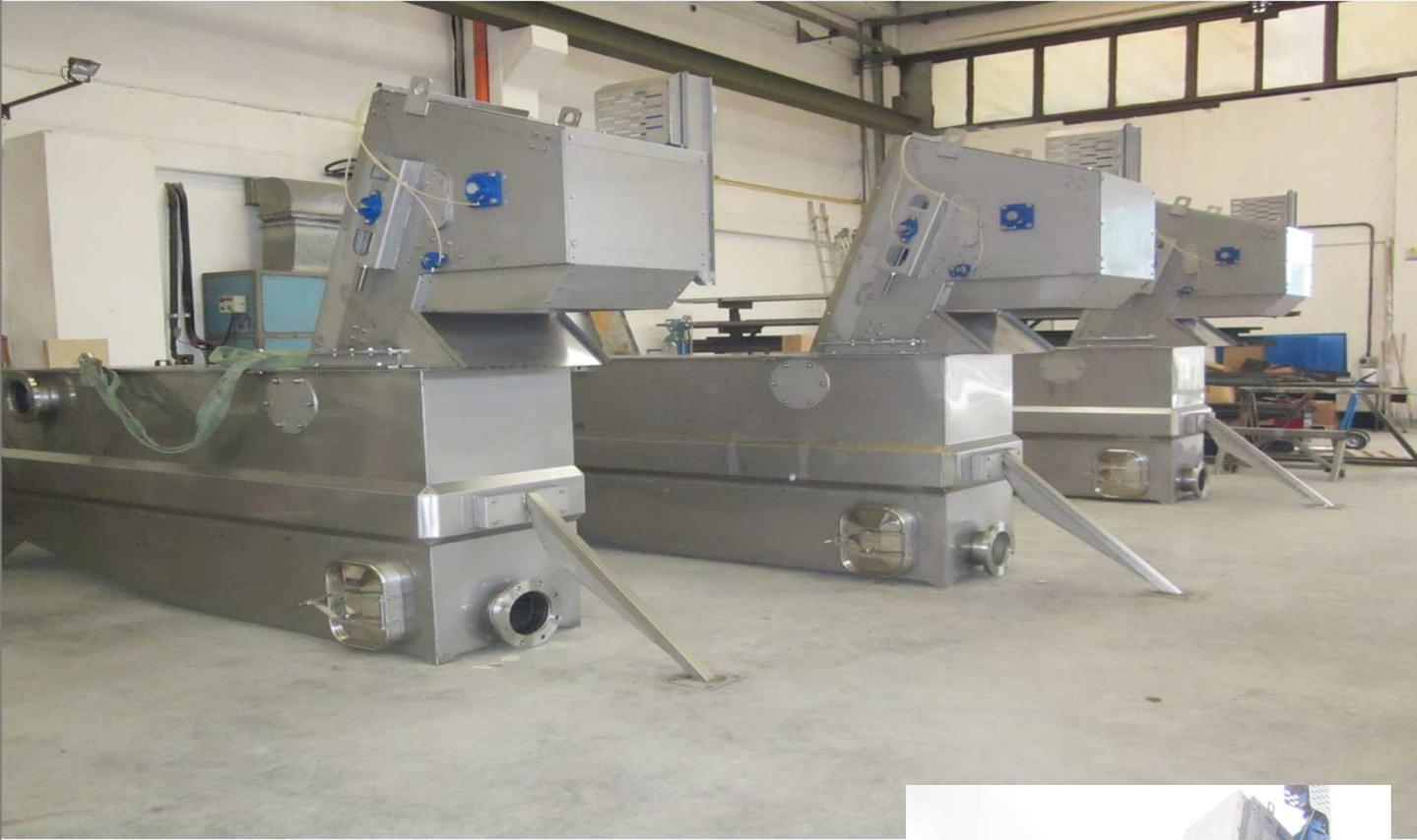
La griglia a nastro è una griglia automatica fine, a ciclo continuo e autopulente. Il tappeto filtrante è costituito da una serie di elementi (denti) assemblati su alberi paralleli in acciaio inossidabile ed è montato su un robusto telaio.
