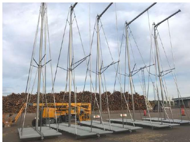
Sistemi estraibili tramite gru con diffusori a disco (a sx) e tubolari (a dx)
